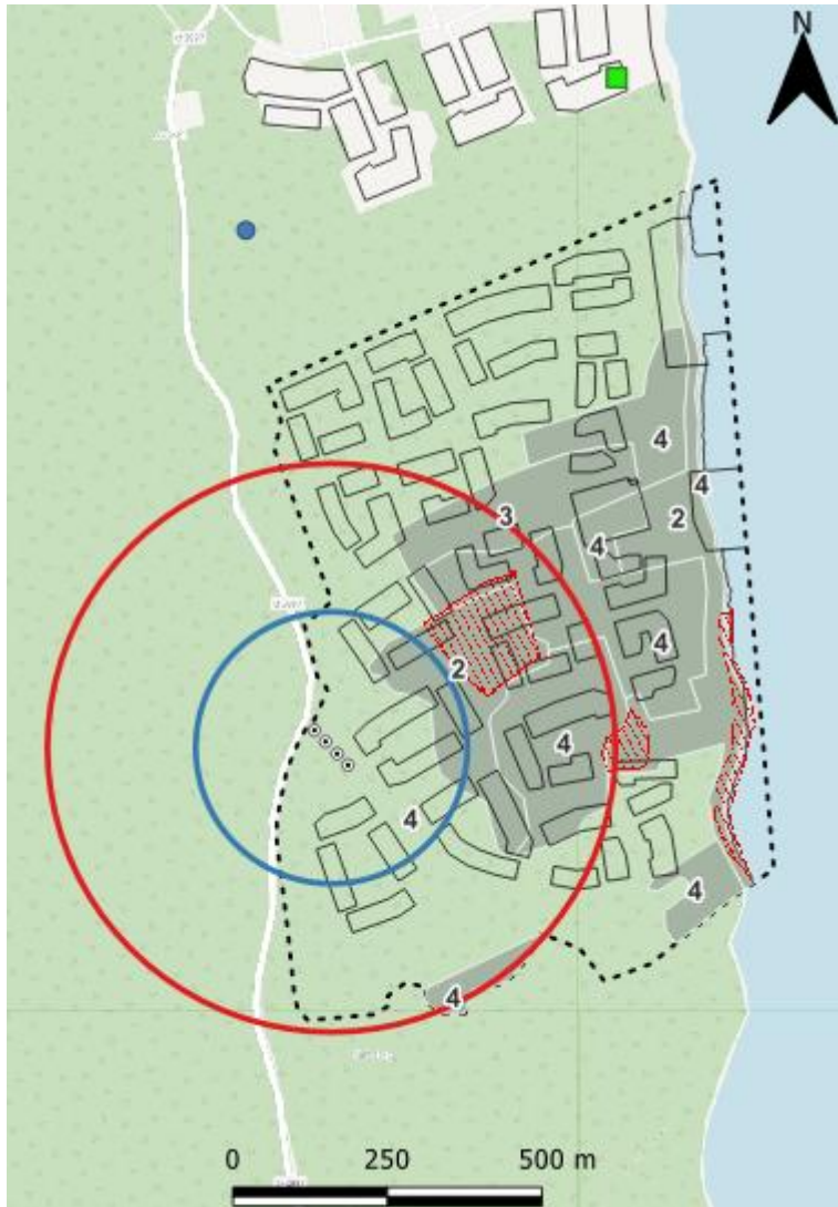
Figur 5: Teoretiskt beräknade maximala influensområden i berg vid cirkulärt antagande: blå cirkel - Etapp 1, röd cirkel – hela planområdet. Planområdet markerad med svart streckad linje och planområdets vattentäkt markerade med vita ringar. Vattentäkt tillhörande fritidshusområdet norr om planområdet markerad med blå punkt, energibrunn markerad med grön kvadrat. Nyckelbiotop (Skogsstyrelsen) markerade med röd skraffering. Objekt med naturvärde identifierade vid naturvärdesinventering markerade med grått och naturvärdesklass anges med siffror 2-4. Bakgrundskarta OpenStreetMap.
