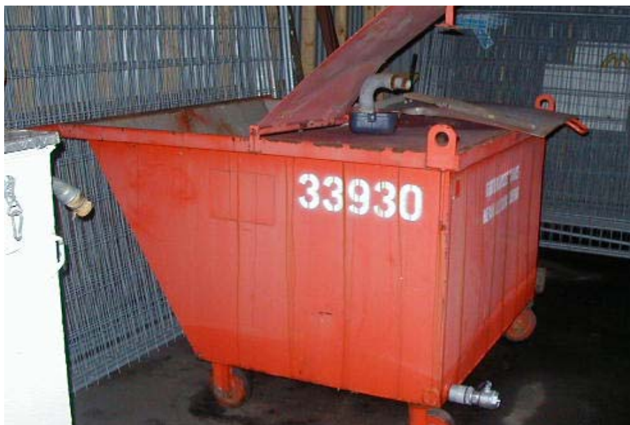
Figur 3. Containern som används till försöket. I nedre delen syns avtappningskranen.
