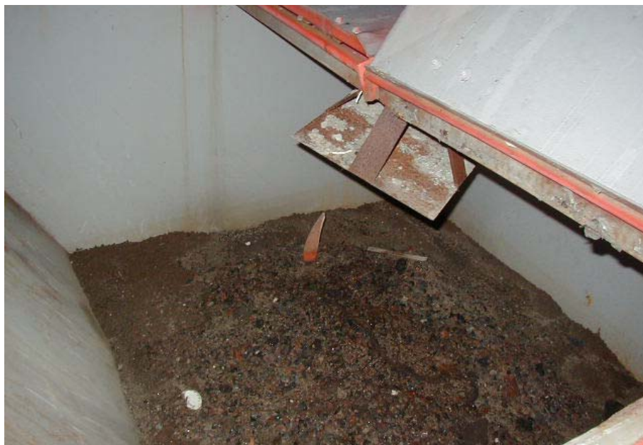
Figur 2. Finkornigt väggrus (0-32 mm) preparerat med diesel som fyllts i containern. I botten av containern finns ett ca 5 cm tjockt lager med Float Absorb.
